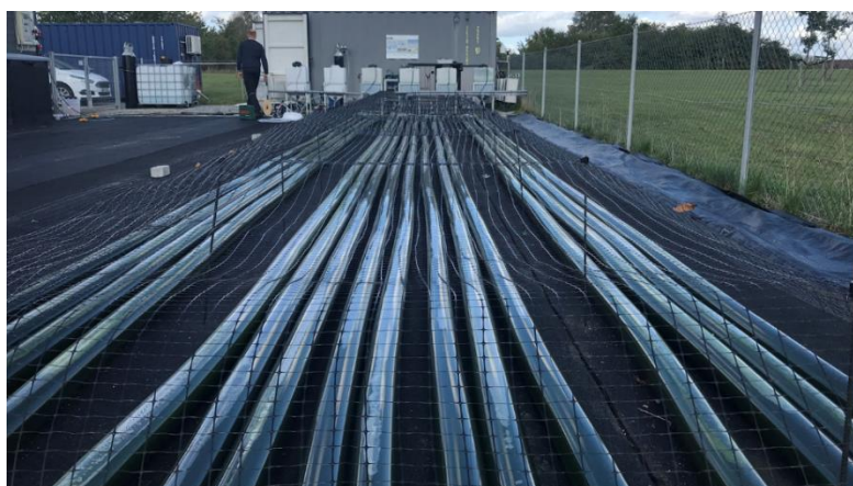
Figur 3: I det danske ReMAPP-projekt udvikles et udendørs, horisontalt algedyrkningsystem bestående af 100 meter lange plastikrør placeret på jorden.
